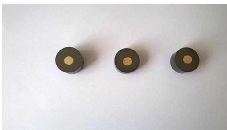
*Slika 28.* Nagriženi uzorci Cu-SMA legura
