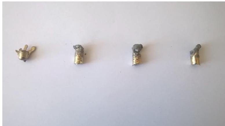
*Slika 23.* CuAlMn legura pripremljena taljenjem u elektrolučnoj peći i lijevanjem u kalup
