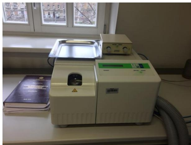
**Slika 31.** Diferencijalni pretražni kalorimetar, MDSC Mettler-Toledo 822e
