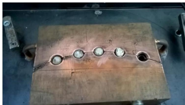
**Slika 22.** Kalup za lijevanje cilindričnih uzoraka
