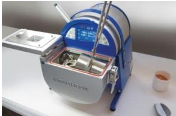
*Slika 24.* Indukcijska peć [37]
