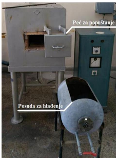
*Slika 25.* Elektrootporna komorna peć za popuštanje [20]
