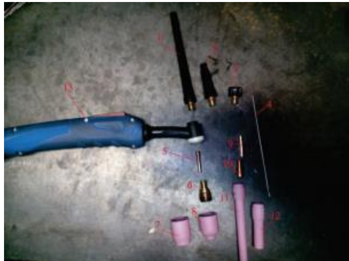
Slika 7. Dijelovi TIG gorionika [8]
