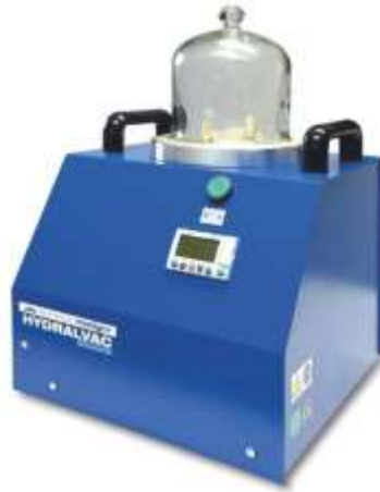
Slika 43. Uređaj za određivanje gustoće Hydralvac 6000
