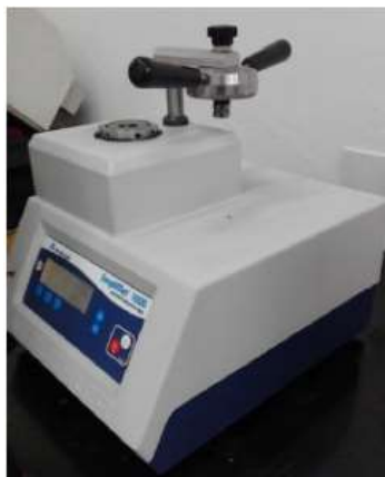
Slika 45. Uređaj za zalijevanje uzoraka SimpliMet 1000
