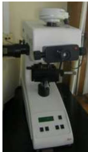
Slika 50. Mikrotvrdomjer Leica VMHR [43]
