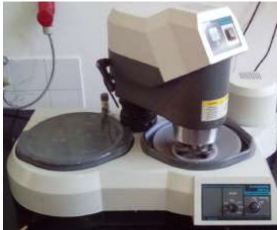
Slika 46. Uređaj za brušenje i poliranje Vector LC
