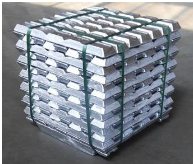
Slika 23. Uložni materijal AlSi12 legure [53]
