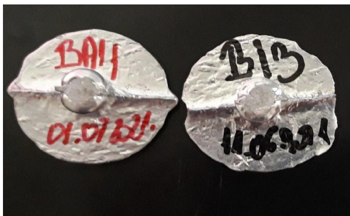
Slika 31. Uzorci za određivanje kemijskog sastava
