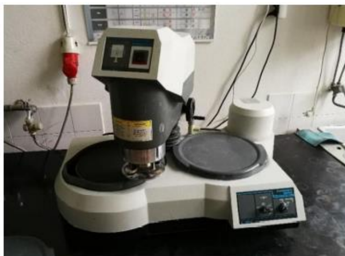
Slika 35. Uređaj Buehler za brušenje i poliranje uzoraka
