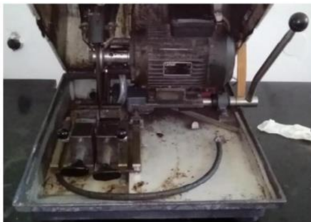
Slika 33. Rezalica Buehler za rezanje uzoraka
