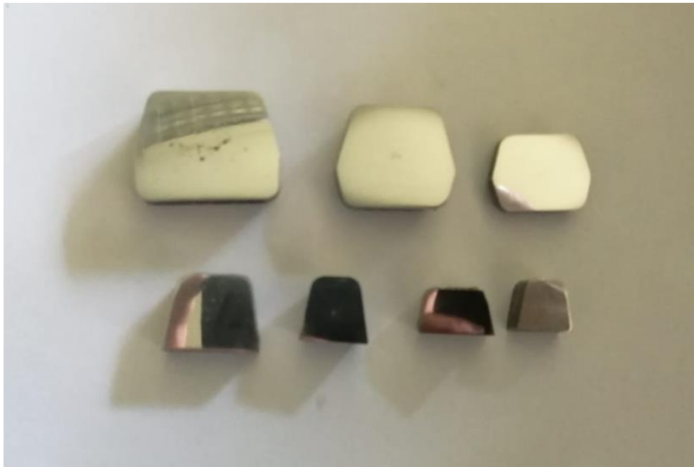
Slika 36. AISi12 uzorci za metalografska ispitivanja
