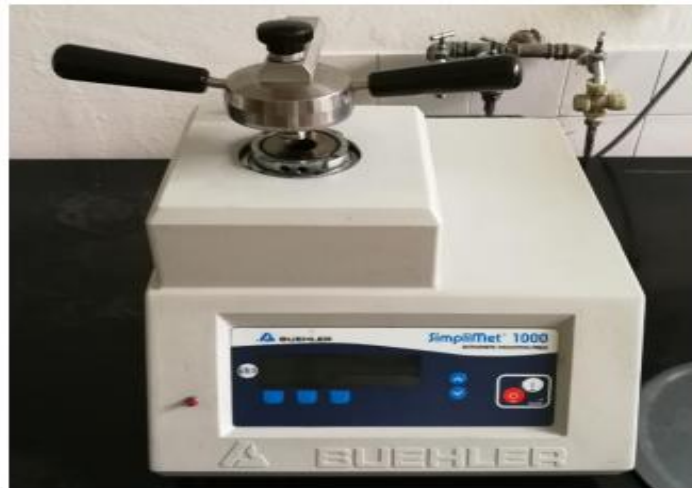
Slika 34. Uređaj Buehler za ulaganje uzorka u vodljivu masu
