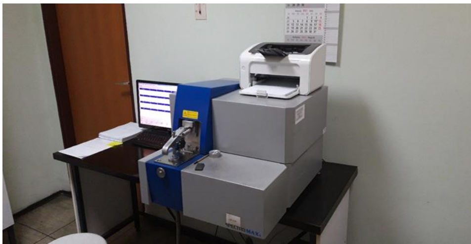
Slika 32. Uređaj Spectromaxx za određivanje kemijskog sastava taline
