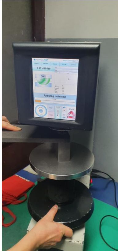
Slika 30. Prikaz ispitivanja tvrdoće na uređaju Inovatest
