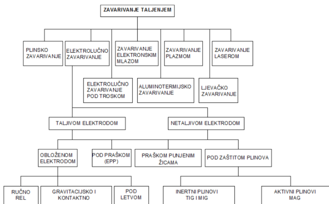
Slika 4. Podjela postupaka zavarivanja taljenjem [5]
