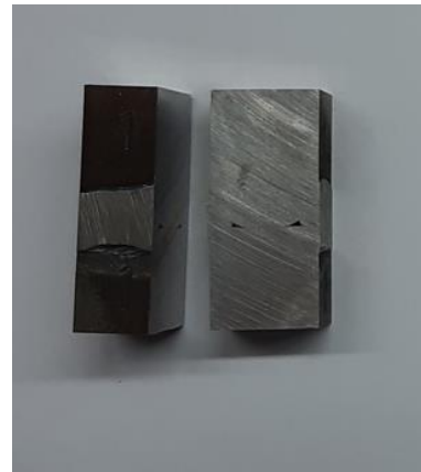
Slika 20. Izrezani uzorci: a) spoja hlađenog na zraku, b) spoja hlađenog u vodi
