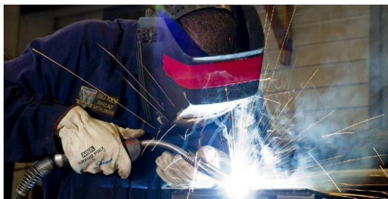
Slika 1. Primjena MIG postupka zavarivanja [3]
