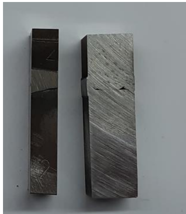
Slika 20. Izrezani uzorci: a) spoja hlađenog na zraku, b) spoja hlađenog u vodi
