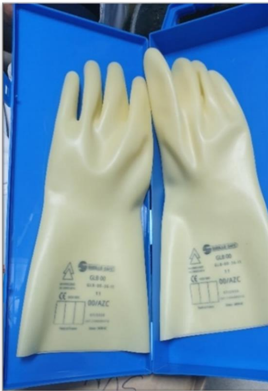
Slika 11. Zaštitne gumene rukavice za rad pod naponom
