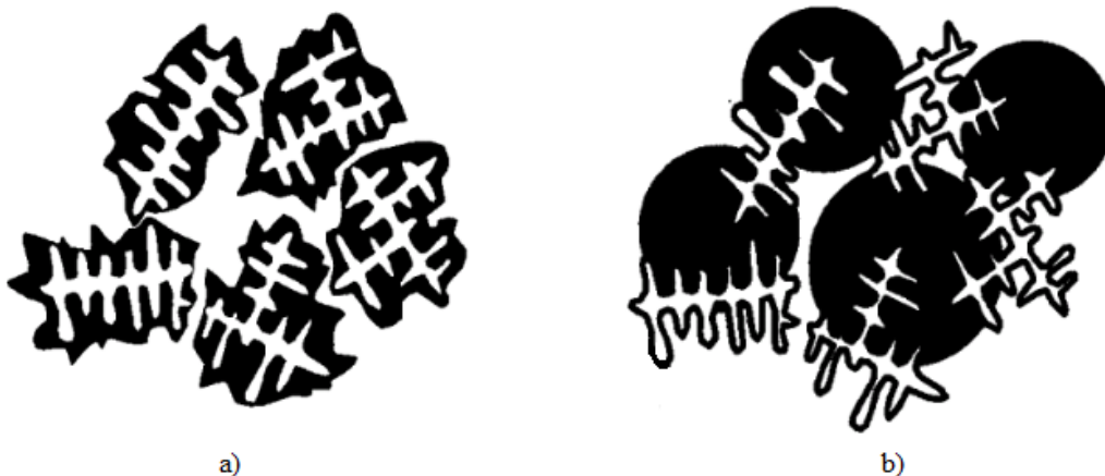
Slika 31. Shematski prikaz nastajanja eutektika prema postojećim mehanizmima [15] a) eutektik nastao prema mehanizmu 1) b) eutektik nastao prema mehanizmu 2)
