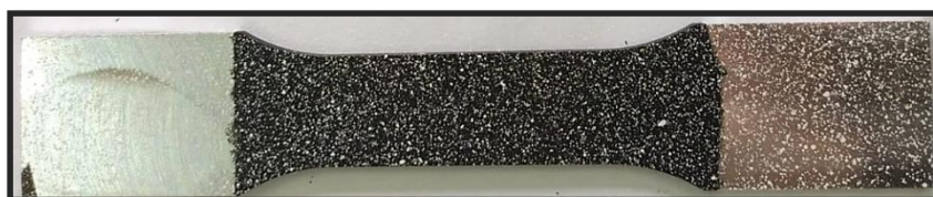
Slika 26. Epruveta s nanesenim bijelim točkicama (markerima)
