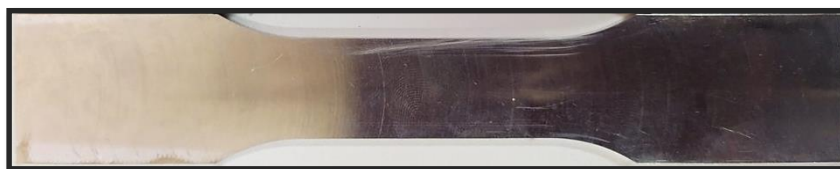
Slika 24. Standardna epruveta aluminijske legure (AlMg 4,5 ) za statičko vlačno ispitivanje
