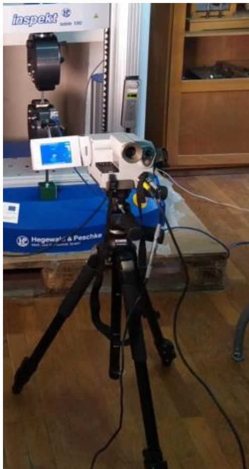
Slika 30. Položaj termalne kamere tijekom ispitivanja
