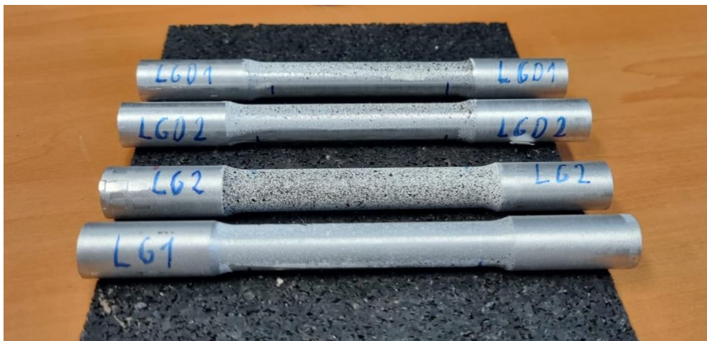
Slika 21. Uzorci okruglog poprečnog presjeka
