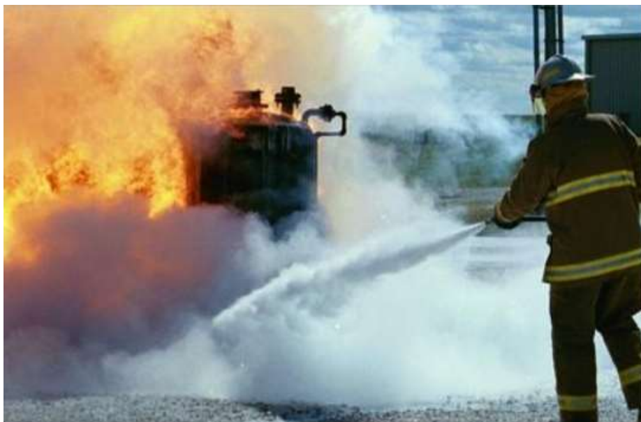
Slika 10. Gašenje požara prahom [11]
