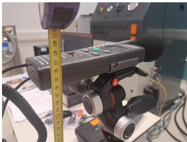
Slika 49 Postavljanje mikrofona na prihvatljivu visinu
