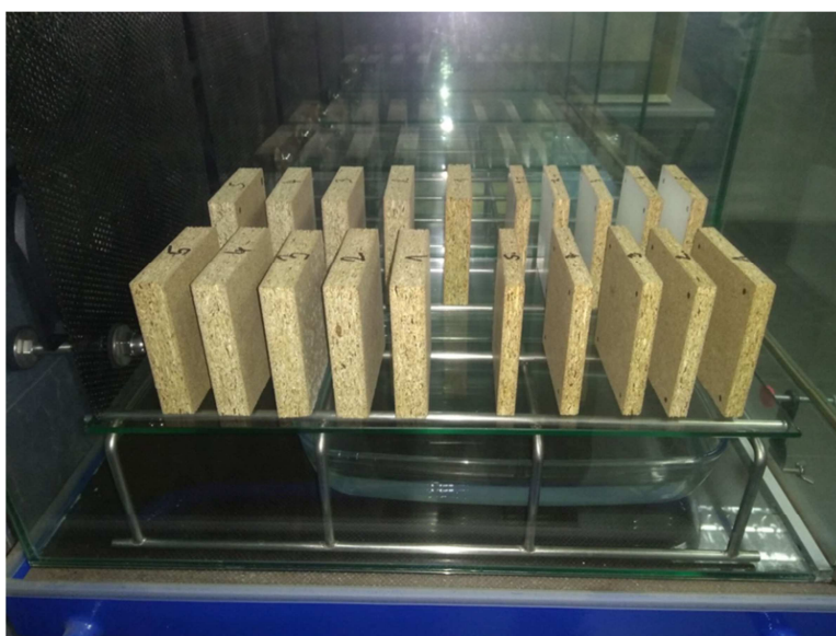
Slika 2. Prikaz uzoraka u komori za klimatizaciju
