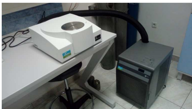
Slika 10. DSC uređaj Perkin Elmer 6000 i Intracooler SP
