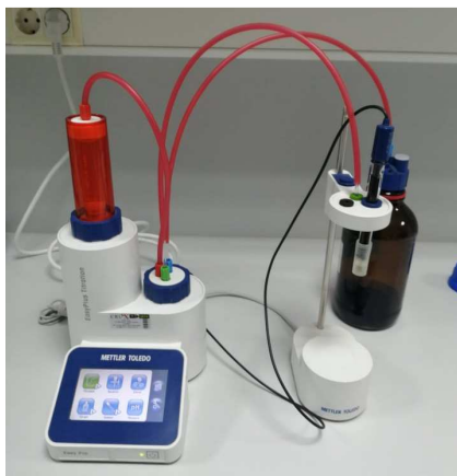
Slika 8. Digitalni titrator Mettler Toledo Easy Pro
