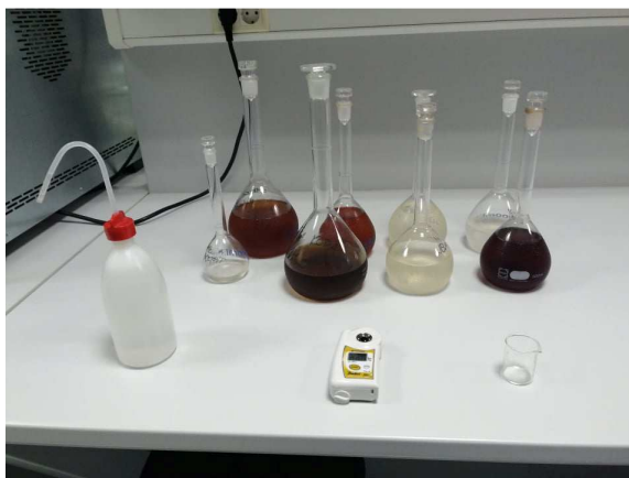
Slika 9. Refraktometar ATAGO Pal- \alpha i ekstrakti kore
