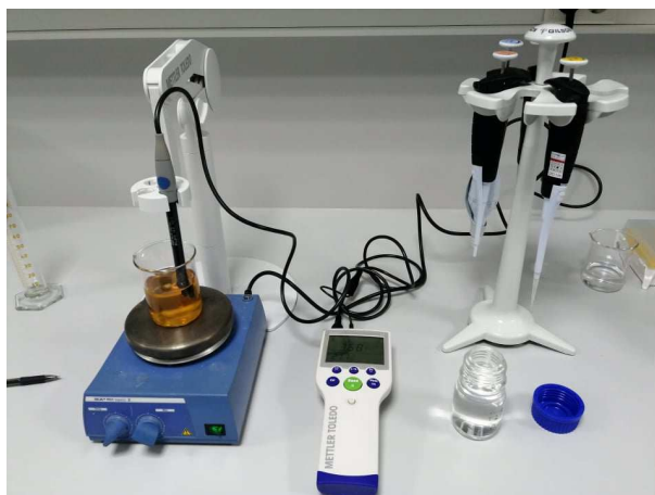
Slika 7. Ručni pipetori i pH metar u trenutku titracije
