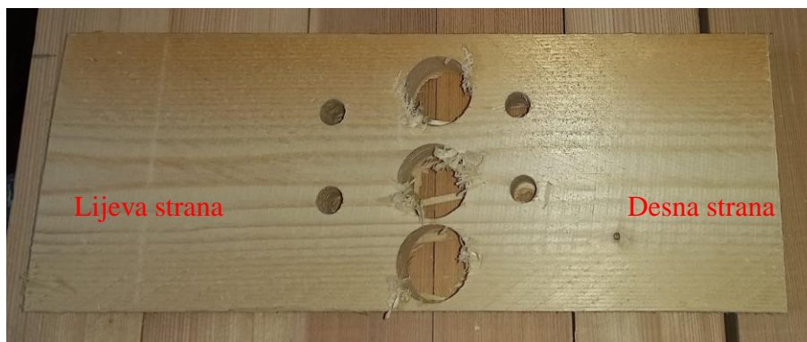
Slika 31. Lijeva i desna pozicija uzimanja strugotine pojedinog uzorka (foto: Sabljak M.,2022)
