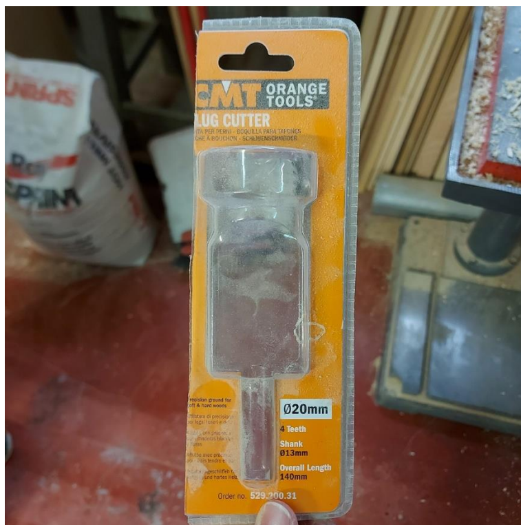
Slika 13. Svrđlo za izradu čepova (foto: Sabljak M.,2022)
