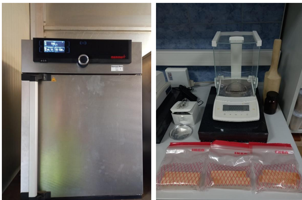
Slika 4. Sušionik i analitička vaga (foto: Sabljak M.,2022)
