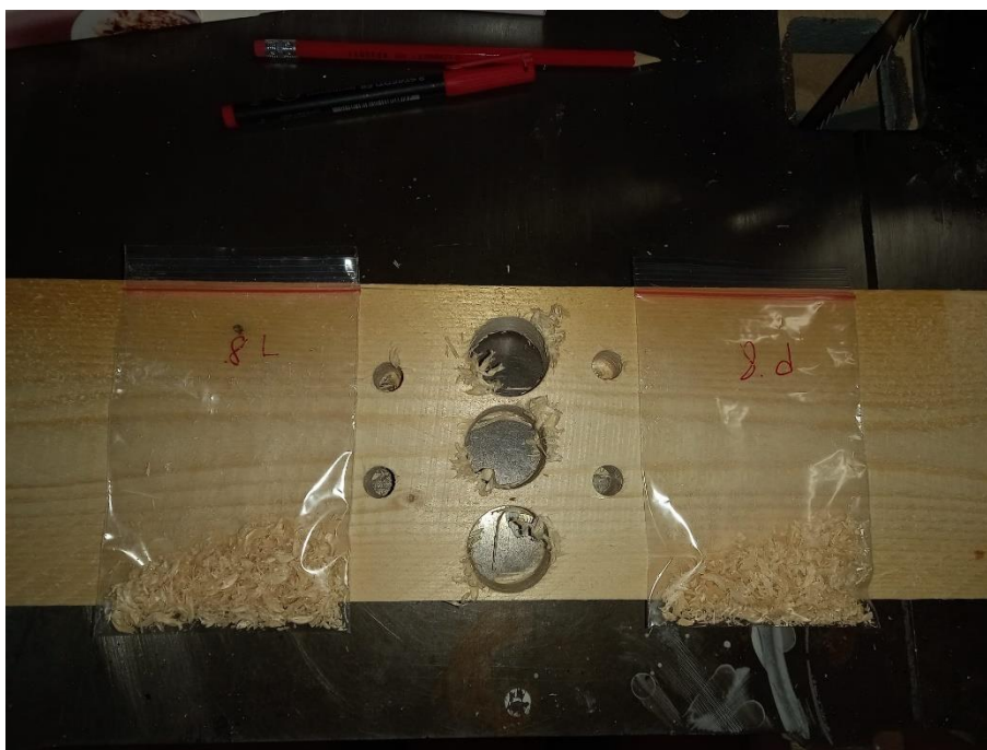
Slika 20. Uzorci lijeve i desne strane zapakirani u nepropusne vrećice (foto: Sabljak M.,2022)
