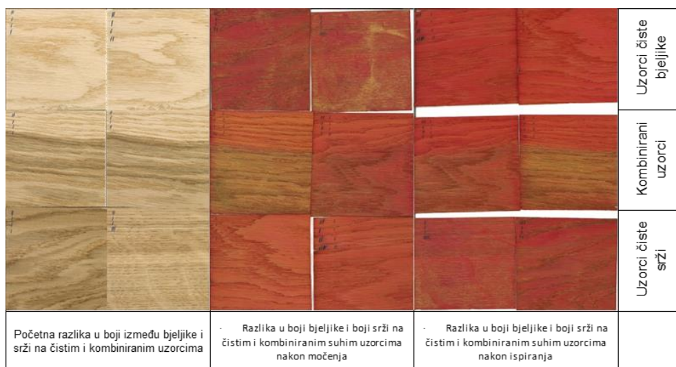
Slika 35. Površinski neobrađeni i uzorci obrađeni anilinskim vodenim močilom pri 30 °C - Ponovljeno
