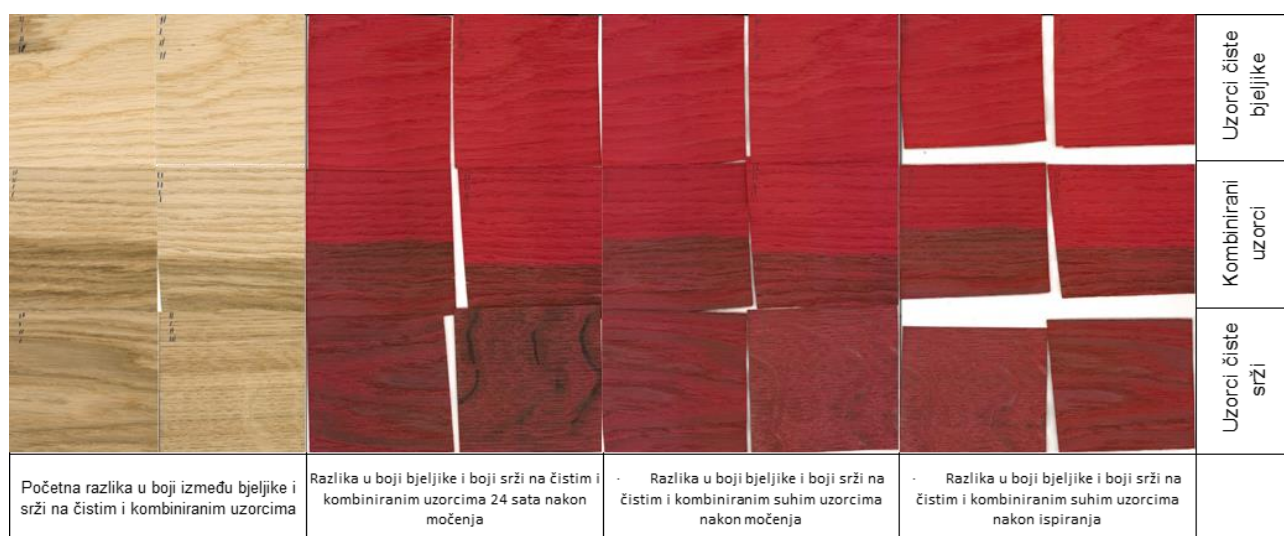
Slika 43. Površinski neobrađeni i uzorci obrađeni reaktivnim močilom na 80 °C
