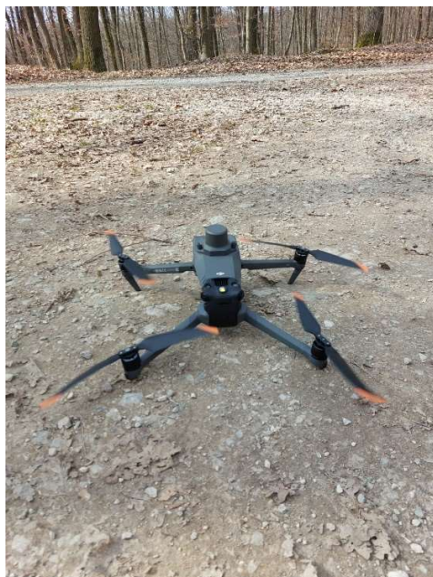
Slika 13. Bespilotna letjelica DJI Mavic 3 Enterprise
