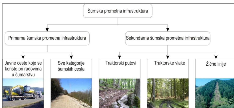
Slika 2. Razredba šumske prometne infrastrukture (Pentek i dr. 2014)
