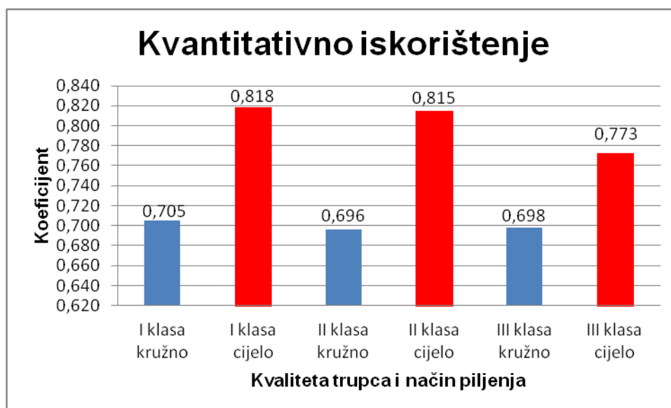
Slika 16. Grafički prikaz kvantitativnog iskorištenja trupaca pri izradi neokrajčenih piljenica
