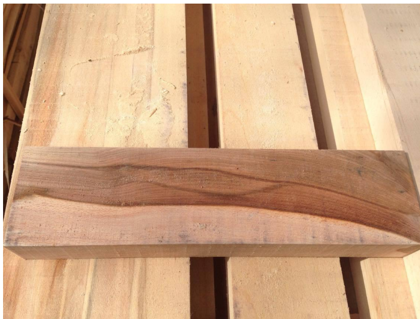
Slika 5. Detalj obratka od bukovine sa obojenim srcem (kern)
