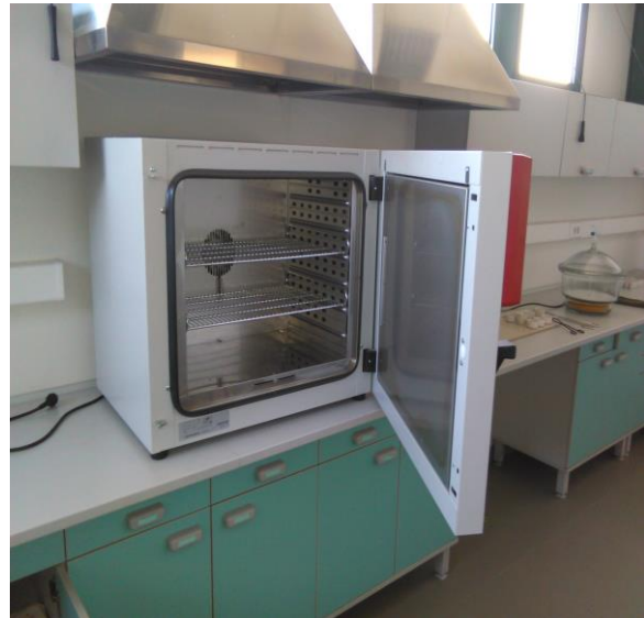
Slika 24. Sušionik BINDER FD 115
