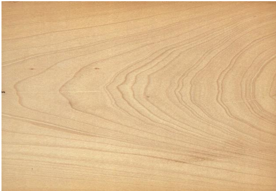
Slika 12: Tangencijalna tekstura javorovine s uočavanjem valovitosti godova ( Acer spp. )
