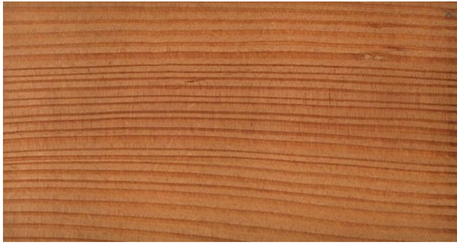
Slika 11: Radijalna tekstura ariševine ( Larix spp. )
