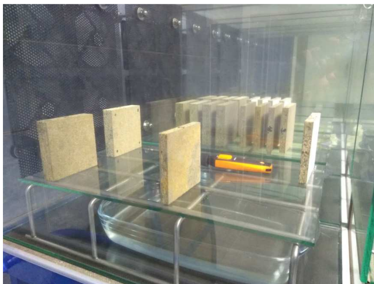
Slika 3. Prikaz mjerenja temperature i relativne vlage u komori po završetku 5. tjedna
