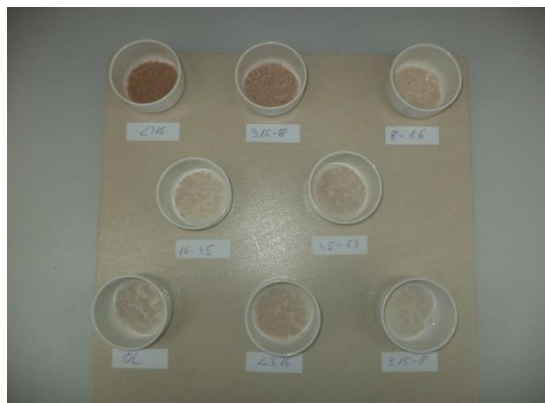
Slika 15. Uzorci nakon žarenja
