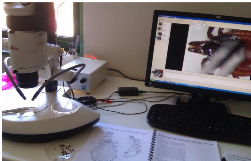
Slika 4.2. Svjetlosni mikroskop Olympus Leica Wild m28 kojim je vršena laboratorijska analiza uzorkovanih krpelja (Vucelja 2013)
