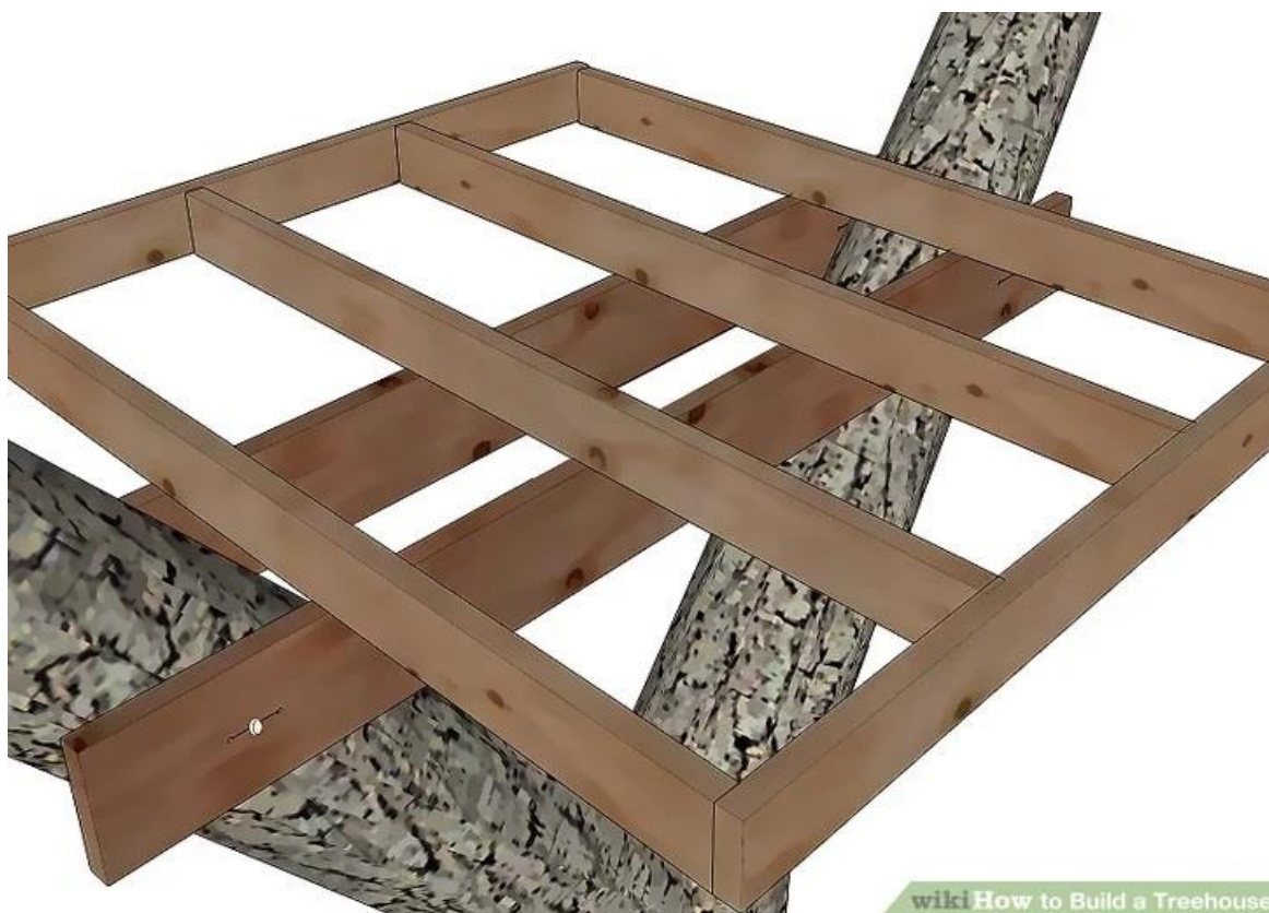
Slika 3. Konstrukcija učvršćena čavlima (izvor: https://www.wikihow.com/Build-a-Treehouse , autor: Creative Commons)
