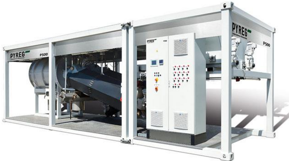
Slika 15. Primjer moderne reakcijske jedinice za proizvodnju biougljena (Fuchs i sur., 2014)
