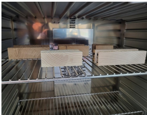
Slika 23. Uzorci "štangica" u sušioniku (foto:Ivanda A., 2024.)
