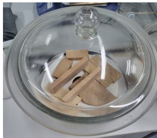
Slika 24. Uzorci "štangica" u eksikatoru (foto:Ivanda A., 2024.)
