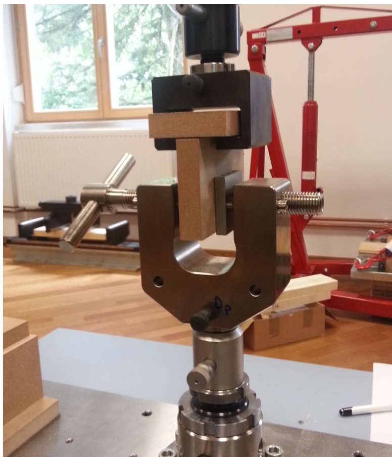
Slika 49. Uzorak T-MDF pri ispitivanju izvlačne čvrstoće
