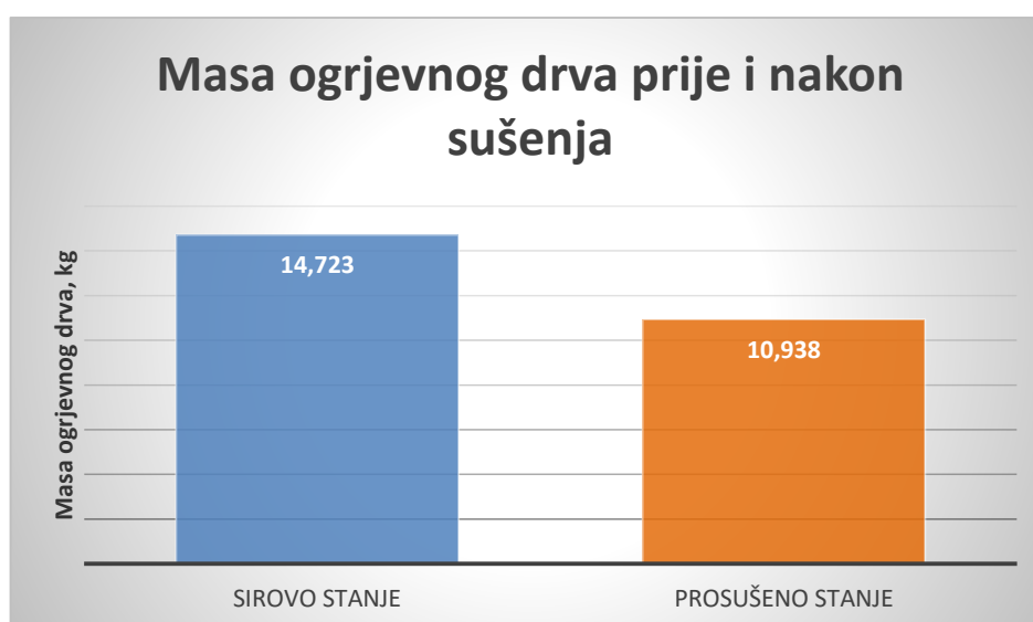
Slika 27. Grafički prikaz mase ogrjevnog drva prije i nakon sušenja
