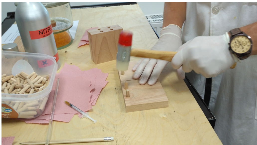
Slika 3. Postavljanje moždanika u plošne rupe
