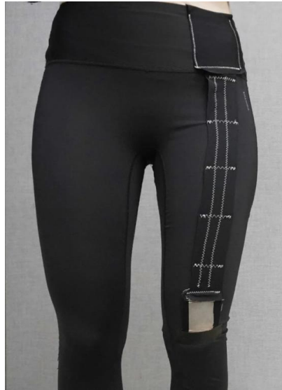
Sl. 14. Razvoj pametnih tajica sa senzorom za mjerenje kretanja [33]
