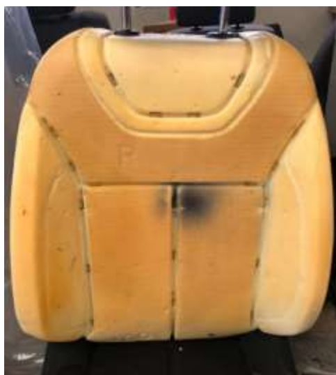
Slika 5. Izgled sjedala bez pokrivnog dijela (poliuretanska ispuna)
