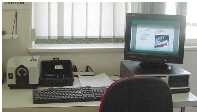
Slika 13: Remisijski spektrofotometar Spectraflash SF 300, tt. Datacolor
