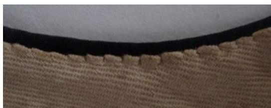
Slika 51: Ručni šav koji spaja podstavu za osnovnu tkaninu
