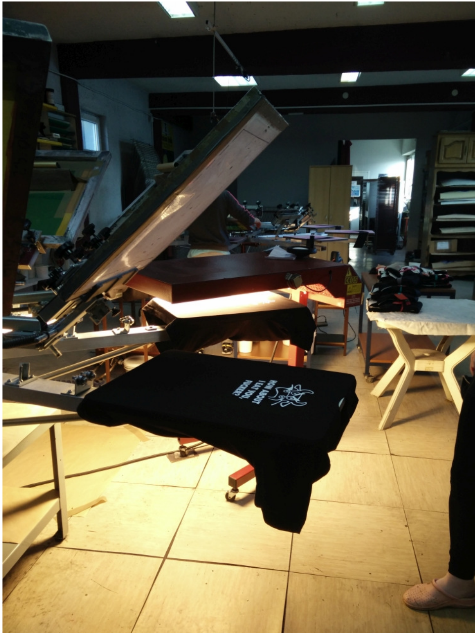
Slika 19: Automatsko sušenje tiska svjetlom
