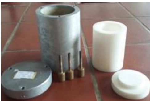
Sl.14.Slika autoklava u kojemu su provedene solvotermalne reakcije
