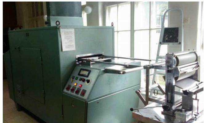
**Slika 7.** Rastezni sušionik tvrtke Benz s fularom
