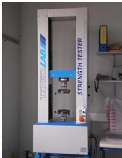
Slika 9. Dinamometar MESDAN-LAB Strength Tester
