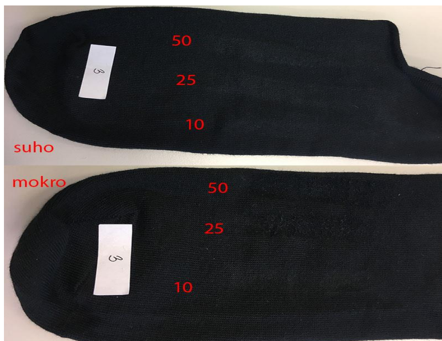
Slika 26. Prikaz tragova suhog i mokrog trljanja na uzorku 3 uz pripadajuće oznake broja ponavljanja
