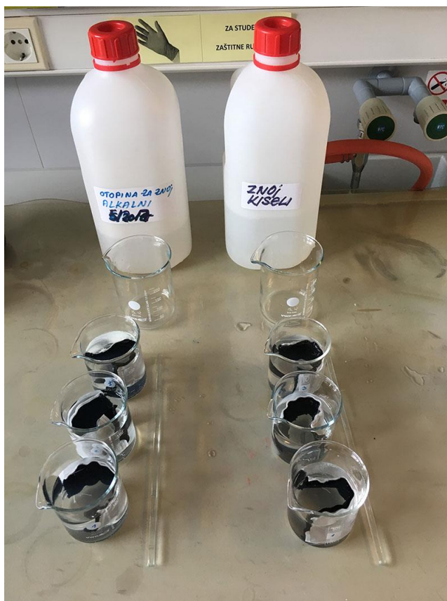
Slika 16. Uzorci u postupku ispitivanja postojanosti obojenja na znoj (alkalni i kiseli)
