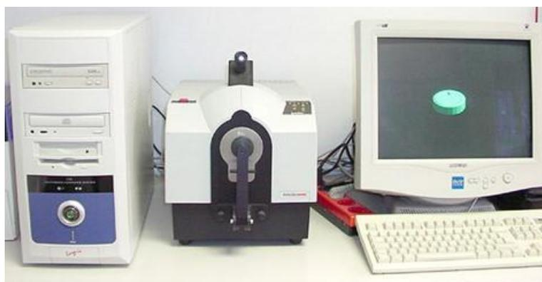
*Slika 27. Spektrofotometar DataColor Spectra Flas 600 PLUS – CT [88]*
