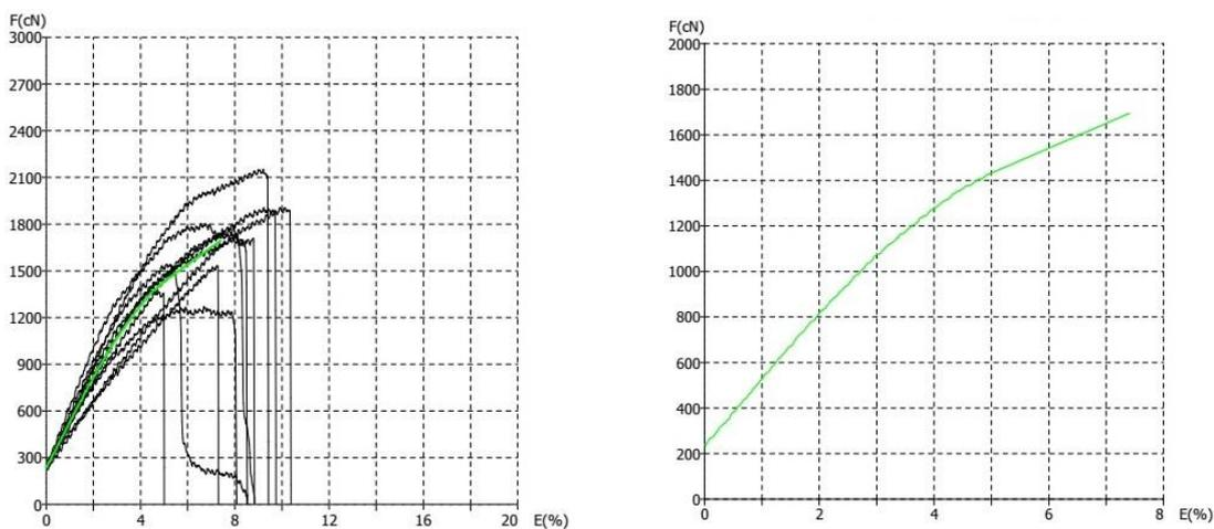
*Slika 34. Grafički prikaz prekidna sila/prekidno istezanje i prosječna prekidna sila/prosječno prekidno istezanje ručno predene pređe domaće pramenke*
