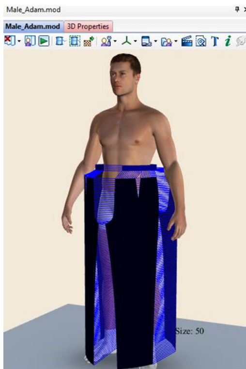
Slika 43 Pozicioniranje krojnih dijelova hlača na 3D računalni parametarski model tijela
