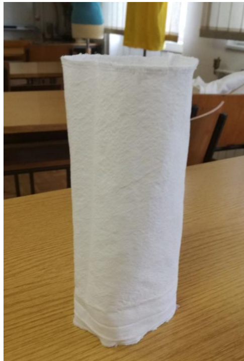
Slika 6. Uzorak koji se koristi za ispitivanje generiranja prašine
