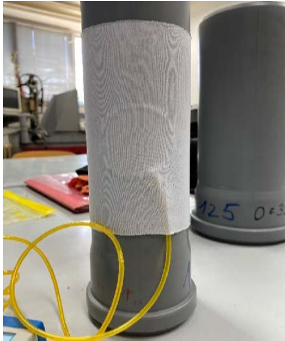
SI. 13. Pico Press senzor ispod uzorka prilikom ispitivanja
