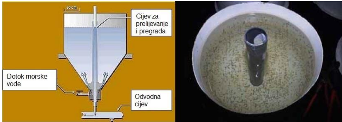
Slika 5. Shematski prikaz inkubatora i slika inkubatora za ličinke hlapa
