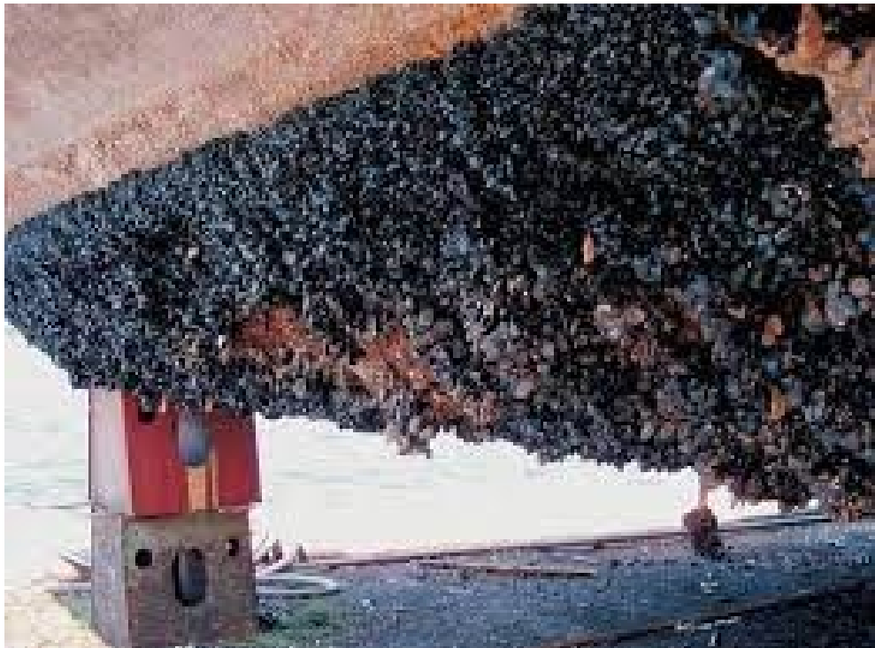
Slika 12. Obraštanje na brodskom trupu; Izvor [13]
