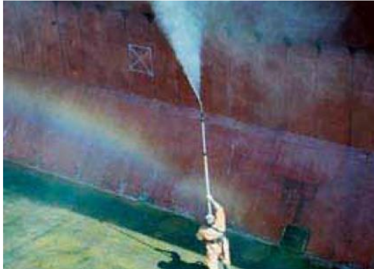
Slika 31. Pranje visokotlačnim peračem na malom brodu za prijevoz rasutih tereta do visine 8 metara nakon tereta soli
