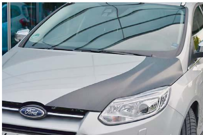
Slika 44. Fordov poklopac motora ojačan ugljikovim vlaknima [3]
