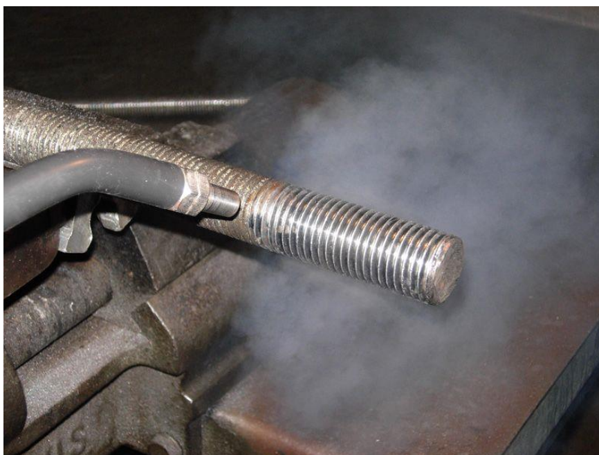
Slika 3.4 Čišćenje pomoću para za odmašćivanje [38]
