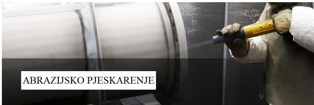
Slika 3.1 Abrazijsko pjeskarenje cijevi [35]
