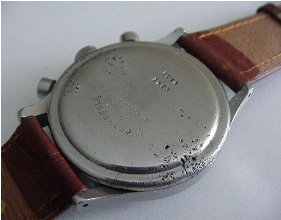
Slika 2.10 Točkasta korozija ručnog sata [28]
