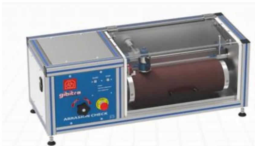
*Slika 18. Gibitre Abrasiometre A- uređaj za ispitivanje trošenja*
