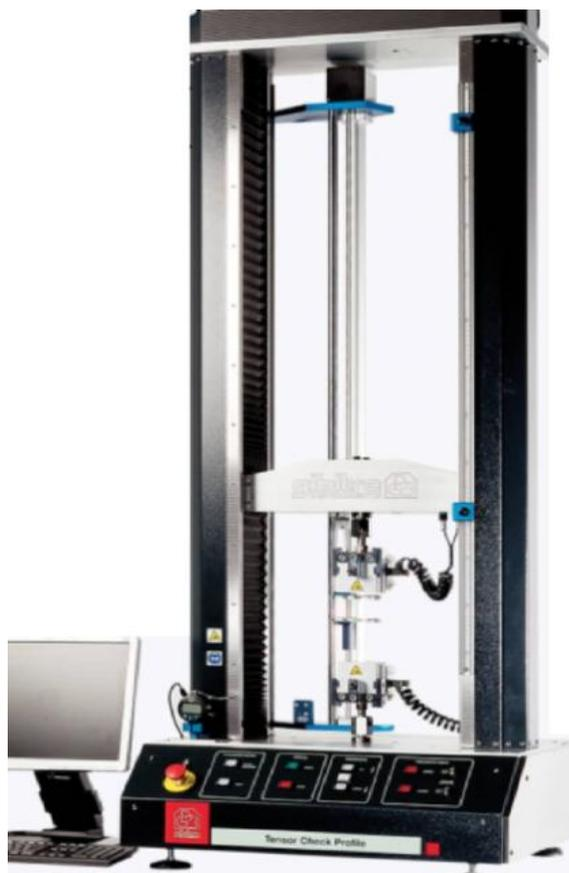
*Slika 17. Kidalica Tensor Check Profile*
