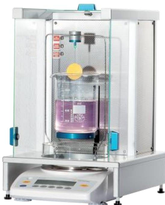
*Slika 19. Gibitre Density Check - uređaj za ispitivanje gustoće*
