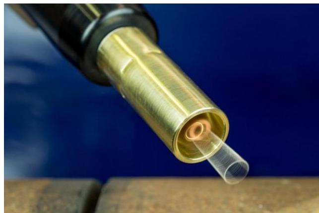
Slika 4.5.2. Izgled rotacije žice kod zavarivanja rotirajućim lukom.[14]
