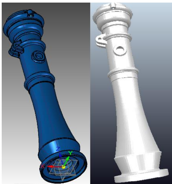
Slika 2.26 Stalak u SolidEdge-u i V-REP-u
