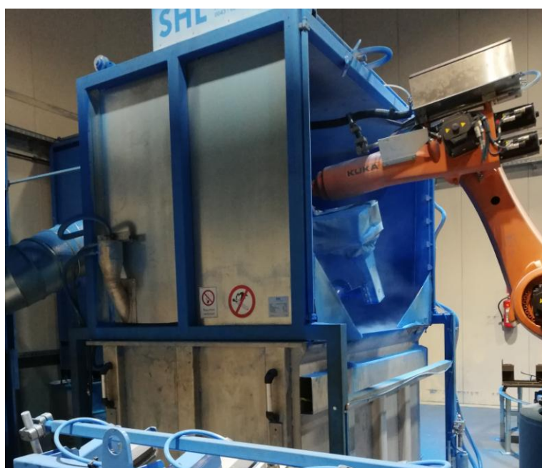
Slika 2.14 Bazen za fluidizaciju praha [13]
