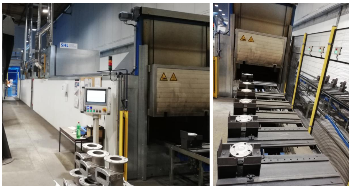
Slika 2.12 Peć za predgrijavanje odljevaka [13]
