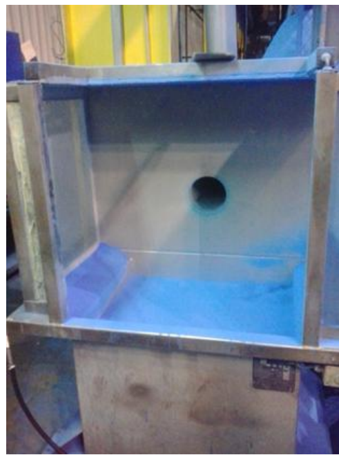
Slika 2.9 Predgrijavanje komada i komora za fluidizaciju [13]
