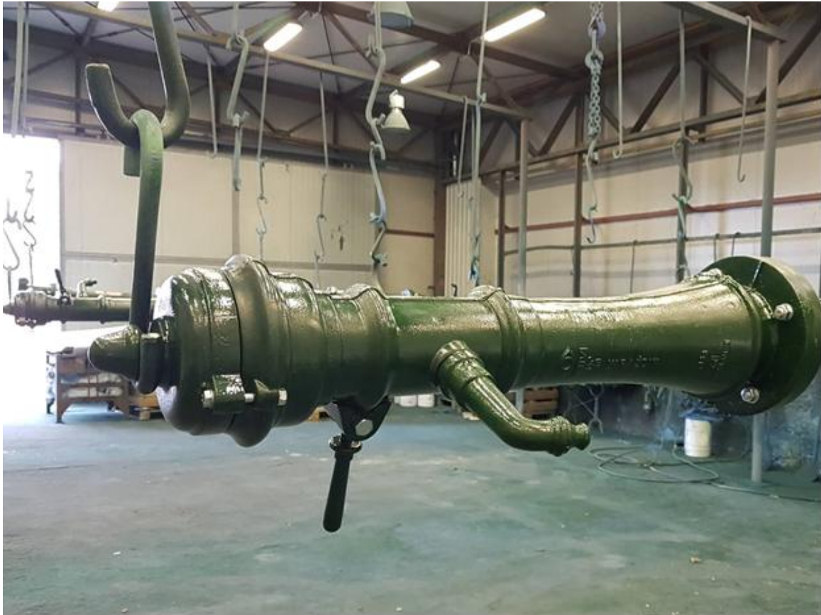
Slika 2.5 Postupak bojenja ručnim raspršivačem [6]
