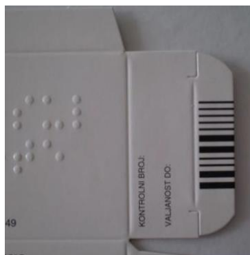
Slika 39. Linijski kod za zatvaranje
