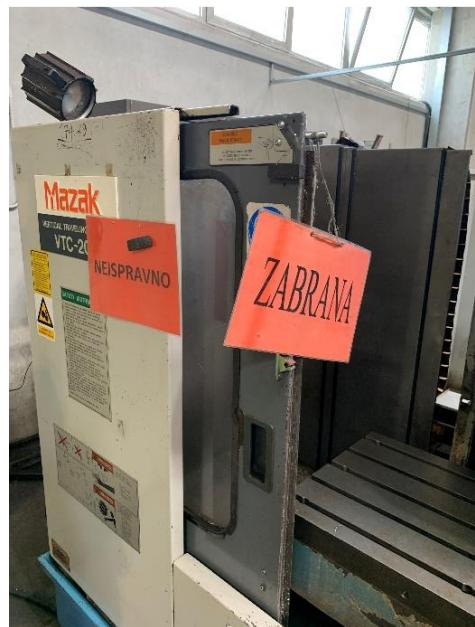
Slika 43. Zabrana korištenja neispravne CNC glodalice
